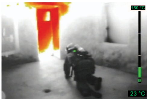
Режим Высокой Чувствительности: обратите внимание на различные перепады температур
